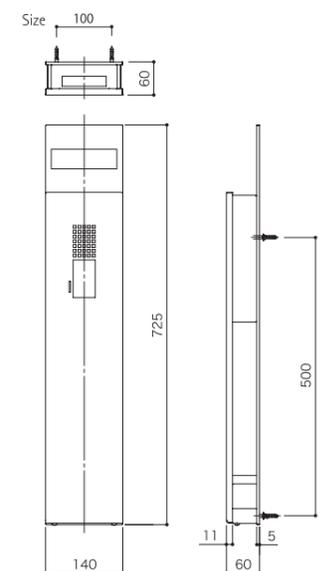
●本体には、インターホン子機・本体は含まれておりません。別途ご購入ください。 ●雨が掛かる場所への設置はさけてください。 ●照明、及びインターホン子機の配線工事は電気工事士有資格者が行ってください。 ●照明の配線工事には必ず第3種接地工事を行い、電源供給には漏電ブレーカーを介してください。 ●適合するインターホンカバーは表記以外にも特注対応可能ですので、別途ご相談ください。 ●SD対応品とは共同住宅で使用する自動火災報知設備の機能を持つ戸外表示機(インターホン子機)について、インターホン工業会の自主管理基準に適合した商品です。 ●総務省令第40号及び告示基準が定められた共同住宅には、SD対応戸外表示機が必要となります。 ●お客様のご要望にお応えするため、当社では特注品も承っています。お気軽にご相談ください。
