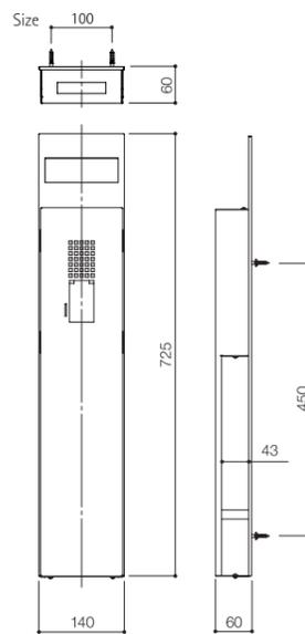
●本体には、インターホン機本体は含まれておりません。別途ご注文ください。 ●雨が掛かる場所への設置はさけてください。 ●照明、及びインターホン機の配線工事は電気工事士有資格者が行ってください。 ●照明の配線工事には必ず第3種接地工事を行い、電源供給には漏電ブレーカーを介してください。 ●適合するインターホンカバーは表記以外にも特注対応可能ですので、別途ご相談ください。 ●SD対応品とは共同住宅で使用する自動火災報知設備の機能を持つ戸外表示機(インターホン機)について、インターホン工業会の自主管理基準に適合した商品です。 ●総務省令第40号及び告示基準が定められた共同住宅には、SD対応戸外表示機が必要となります。 ●お客様のご要望にお応えするため、当社では特注品も承っています。お気軽にご相談ください。
