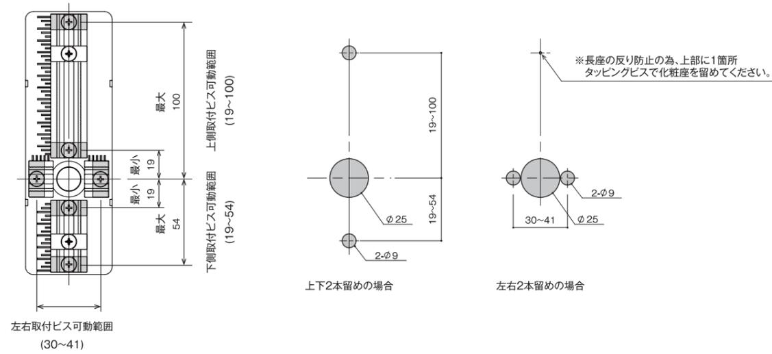
引手・引手鎌錠 納まり図・切欠図
